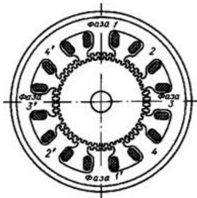
Рис. 2.20. Поперечное сечение четырехфазного реактивного ШД (зубцов ротора 50, число шагов за один оборот 200, угол шага 1,8)
